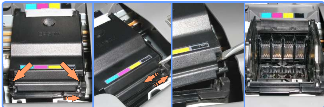
Снятие крышки картриджного отсека CX5900
