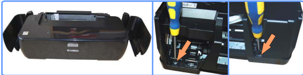
Снятие корпуса iP1800
