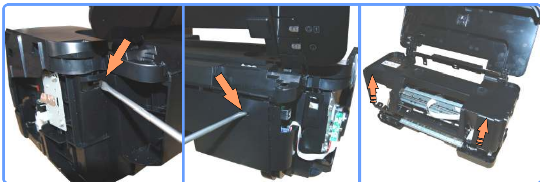
Снятие корпуса iP1800
