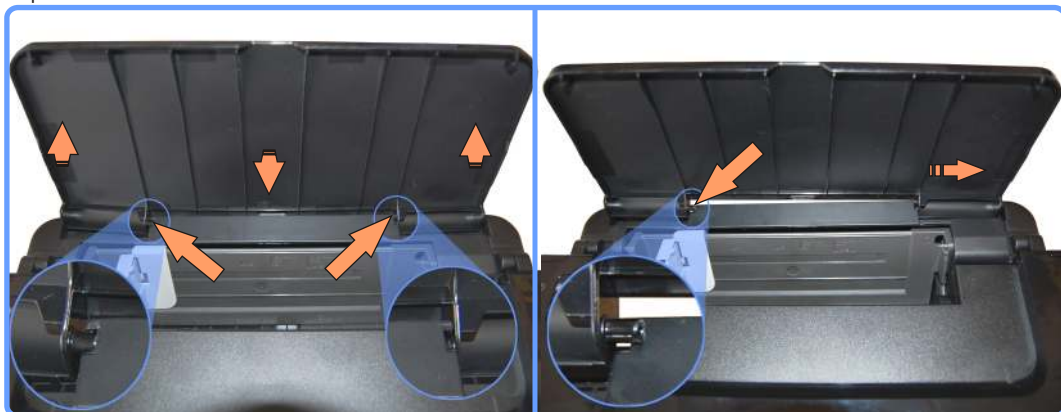
Снятие крышки iP1800
